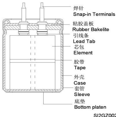
7-2 工艺芯包分解图 (Element drawing)
