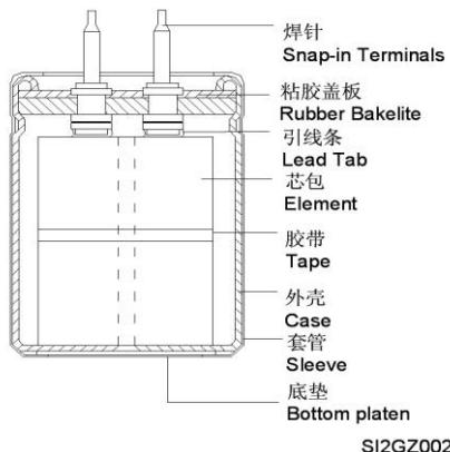
7-2 工艺芯包分解图 (Element drawing)
