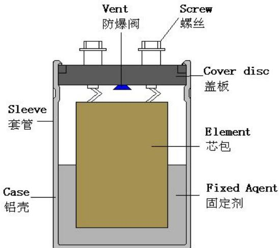
7-2 工艺芯包分解图 (Element drawing)
