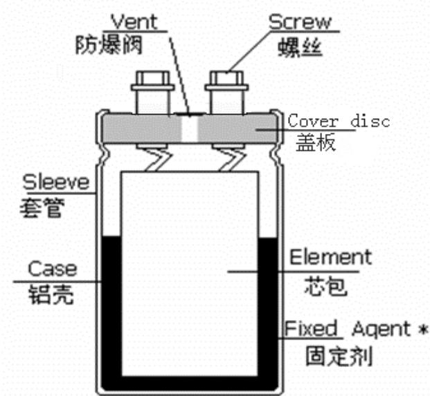
7-2 工艺芯包分解图 (Element drawing)
