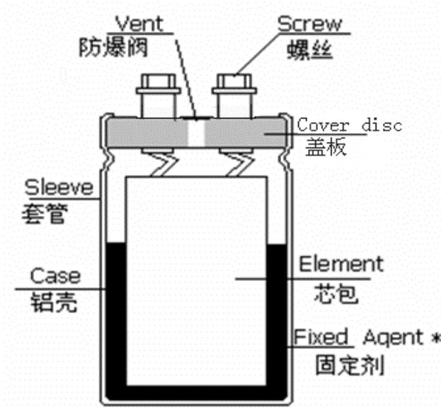
7-2 工艺芯包分解图 (Element drawing)
