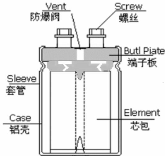
7-2 工艺芯包分解图 (Element drawing)
